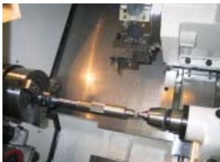
Izdelava predobdelane gredi na CNC stružnici
