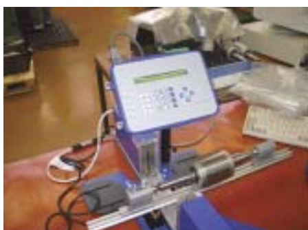
Laserski merilnik za merjenje premerov gredi in rotorja
