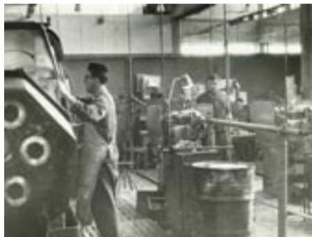
Leta 1964 so v družbi izdelovali ohišja vžigalnih svečk s pomočjo avtomata (na sliki skrajno levo).
