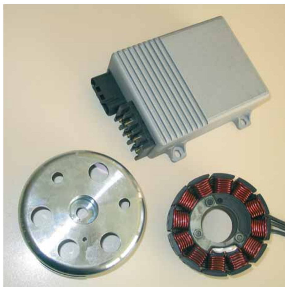
Integrirani starter generator, za katerega je strokovni tim sodelavcev prejel več nagrad, med njimi nagrado GZS.
