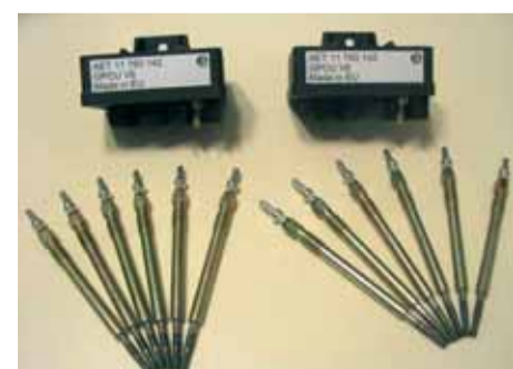
Primerjava FSS svečke (zgoraj) in klasične svečke (spodaj)
