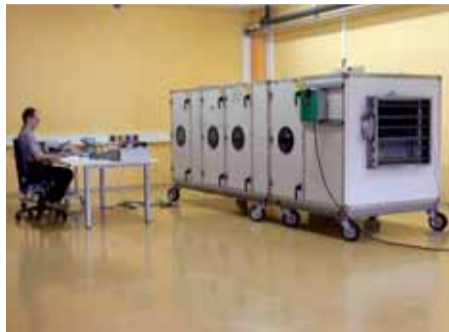
Merilna proga za ventilatorje v Hidria Inštitutu Klima.
