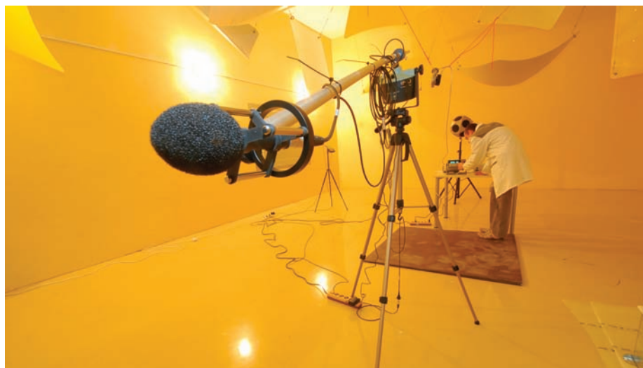
Mikrofon v odmevnici je montiran na konzoli vrtljivega nizkošumnega sistema.
