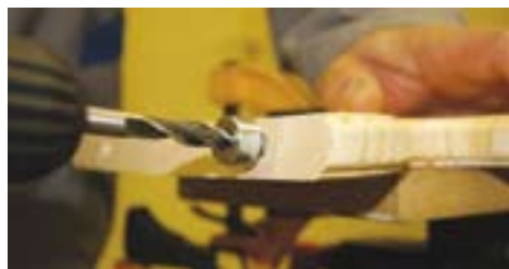
■ [Slika 18] Na označenih mestih izvrtamo izvrtini za moznika
