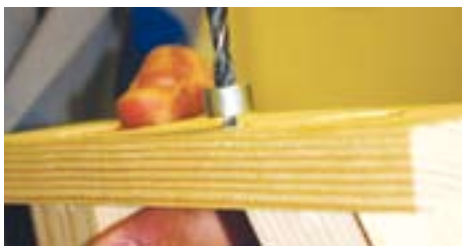
■ [Slika 21] Naredimo izvrtine na povezovalni element
