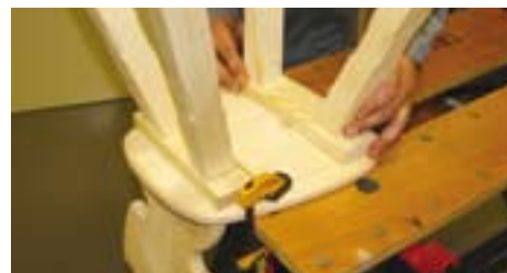
■ [Slika 22] Povezovalna element z nogami pritrdimo na spodnji del sedala
