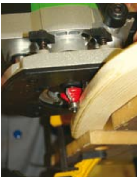
■ [Slika 9a] Robove obdelamo z rezkalnikom
