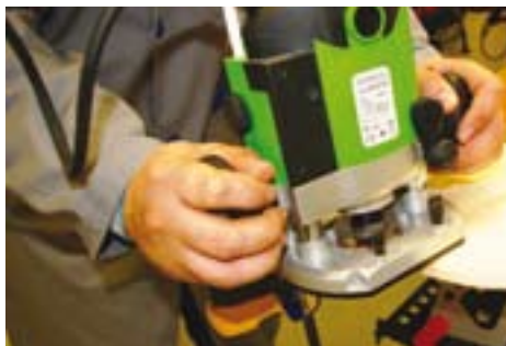
■ [Slika 9] Robove obdelamo z rezkalnikom
