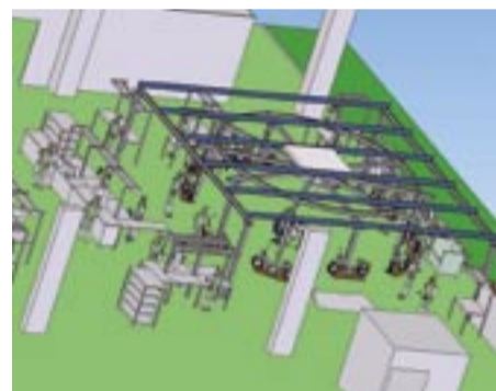
Nova krožna linija dvokoles, ki bo zamenjala tekoči trak, bo omogočala lažje, ergonomsko urejeno in zelo pregledno delo. Omogočala bo normalno velikoserijsko proizvodnjo ter hkratno montažo tudi do deset vozil na najbolj ekonomičen način.
